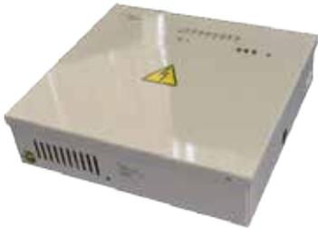
Предназначен для организации охранной и пожарной сигнализации. Осуществляет контроль состояния 8 шлейфов ОПС (до 20 извещателей в каждом), обеспечивая питание датчиков по шлейфу. Позволяет подключать внешние устройства по интерфейсу RS-485, управлять при помощи четырех реле внешними исполнительными устройствами. Программируемая логика работы. Контроллер выполнен в металлическом корпусе, оснащен светодиодной индикацией состояния, имеет резервное питание от аккумулятора.
