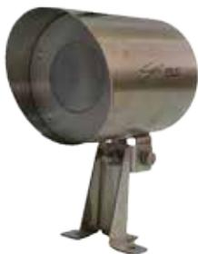
Предназначен для охраны протяженных участков и контроля за перемещениями объектов через охраняемые периметры. Принцип действия извещателя основан на регистрации изменения уровня излучения инфракрасного диапазона, вызываемого перемещением объектов в зоне обнаружения датчика. При пересечении движущимся объектом зоны обнаружения извещатель передает тревожный сигнал.
