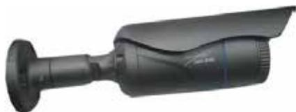
Уличная стационарная видеокамера с ИК-подсветкой. Выполнена в герметичном защитном кожухе. С тыльной стороны видеокамера оборудована интегрированным в корпус поворотным кронштейном, существенно облегчающим процесс монтажа. Видеокамера имеет встроенную ИК-подсветку, с дальностью действия до 30 метров, обеспечивающую работу в полной темноте.
