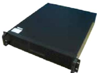
Многофункциональная мини-АТС, позволяющая организовывать голосовую связь по протоколу SIP через компьютерные сети. IP АТС «Аэлиита-1070» предоставляет все основные функции обычной мини-АТС и позволяет создавать корпоративные распределенные телефонные сети. IP АТС «Аэлиита-1070» оснащена контроллером STS-4940, который позволяет осуществлять мониторинг АТС, а также выполнять аппаратный перезапуск в случае отказа. IP АТС «Аэлиита-1070» конструктивно выполнена для монтажа в 19-ти дюймовую стойку.
