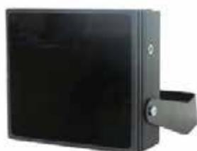
Предназначен для освещения охраняемой территории в ночное время суток на ближних и средних дистанциях. Выполнен в герметичном корпусе из алюминиевого сплава. Пржектор содержит излучающую матрицу на основе мощных светодиодов со встроенной формирующей оптикой. Задняя часть корпуса имеет развитую поверхность в виде ребер охлаждения.
