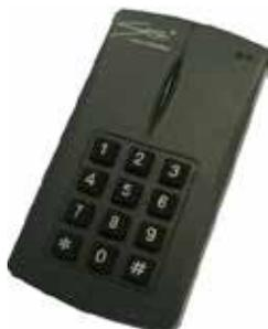
Предназначена для передачи идентификационного кода карты или кода, введенного с клавиатуры, контроллеру СКУД. Обеспечивает ввод кода («пароля») и считывание идентификационного признака с проксимити-карты (брелка) стандарта EM-Marine с дальнейшей передачей полученного кода контроллеру СКУД.
