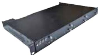
Видеосервер STS-312 предназначен для преобразования видеосигнала от двенадцати аналоговых видеокамер в цифровой формат и трансляции его по сети Ethernet. Видеосервер STS-312 позволяет организовать двухстороннюю аудиосвязь, имеет три дуплексных аудиоканала.
